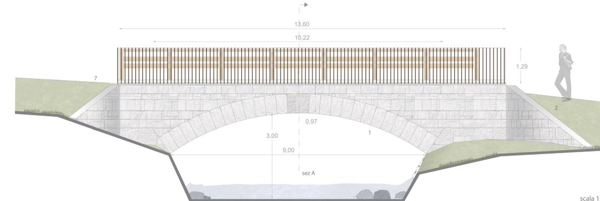
**dettaglio costruttivo del ponte carrabile**
