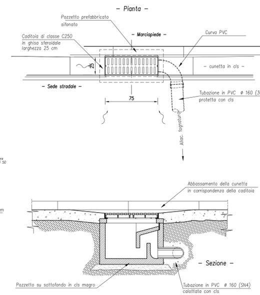
DETTAGLIO DI COLLEGAMENTO AL COLLETTORE
