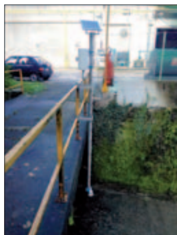
Immagine 2.5. A) Stazione meteorologica nella località Via Emilio Cravos 31 e b) flussometro sulla località Via Brigata Casale 70. Le misurazioni di entrambe le stazioni sono disponibili sulla pagina internet ( http://tpdata.info/c17/ ).
